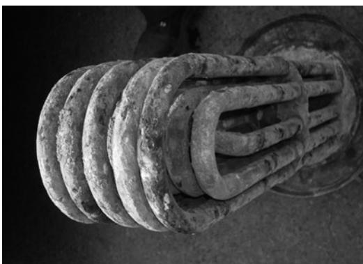
Fig 1. Elemento de calefacción con depósitos calcáreos
