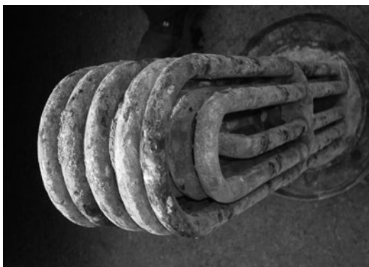
Fig. 1. Élément de chauffage affecté par les dépôts de calcaire
