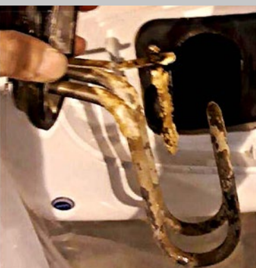
Photos 4 et 5. 3 semaines après l'installation de Vulcan, le calcaire initial a été éliminé.
