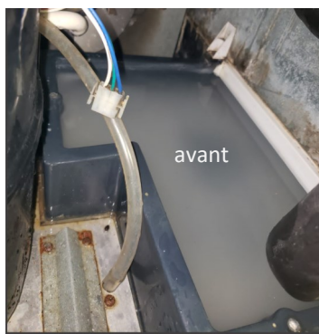
Dans certaines parties de la machine à glace, le calcaire a commencé à se détacher.
