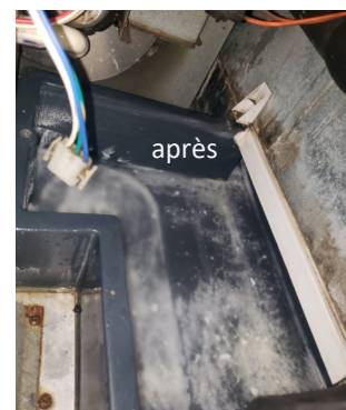
Dans certaines parties de la machine à glace, le calcaire a commencé à se détacher.
