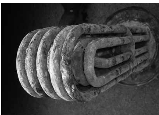
Рис. 1. Нагревательный элемент с накипным отложением
