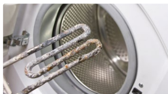
Elemento riscaldante della lavatrice
